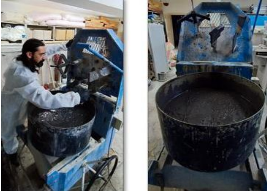
Şekil 1: Atık malzemelerin homojenleştirme işlemi
