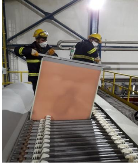
Şekil 3: Mazıdağı tesislerinde katot bakır üretimi
