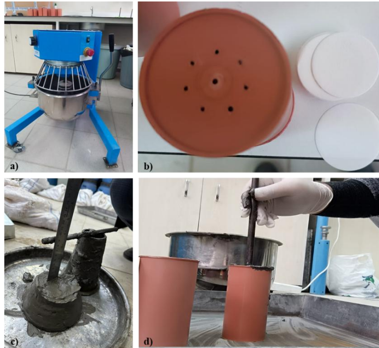
Şekil 2: Macun dolgu karışımında kullanılan mikser (a), dolgu kalıpları ve drenajı (b), slump (çökme) deneyi (c) ve numunelerin kalıba doldurulması (d)
